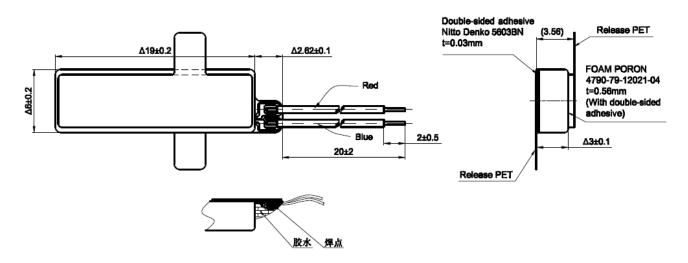
默认的连接形式为20mm长AWG32导线(剥头2mm),可根据客户要求换成连接器、电极弹簧等其它连接形式。
